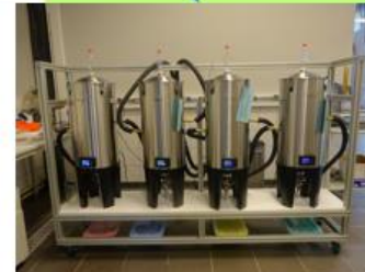
Cuves de fermentation (27 L) avec refroidisseur au glycol
